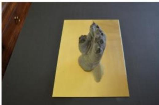
moulage en béton de 10 cm de haut posé au centre d'une plaque de laiton de 18 x 27 cm.
